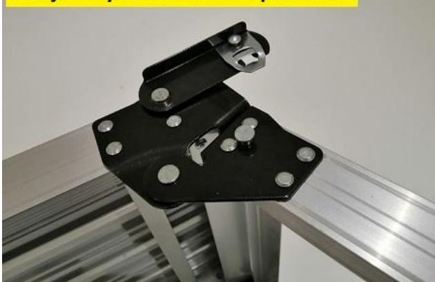
nezajištěný zámek - zákaz používání
